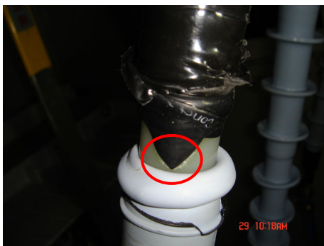
a. 半導體膠帶纏繞不良造成的放電
