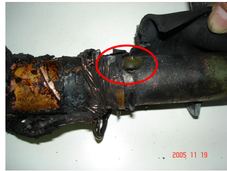
圖 14：應力錐未套入外半導體造成的事故
