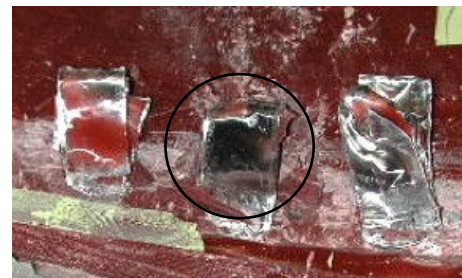
圖 17：案例一變壓器解剖後找到的放電位置
