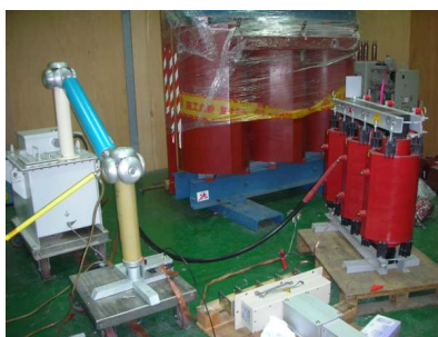
圖 5：現場實際測試接線圖
