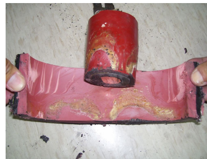
圖 12：電纜接續匣內部放電狀態
