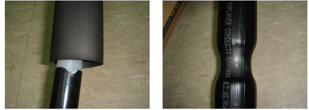
a.外半導與應力錐的瑕疵 b.熱縮不完整
