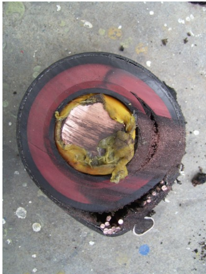
圖18 異常中間接續閘解剖圖面
