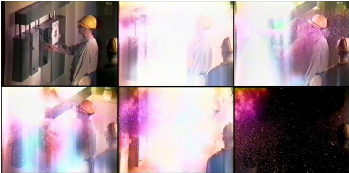
圖 1. 操作電盤發生電弧之模擬狀況 (圖片來源: openelectrical.org) [8]
